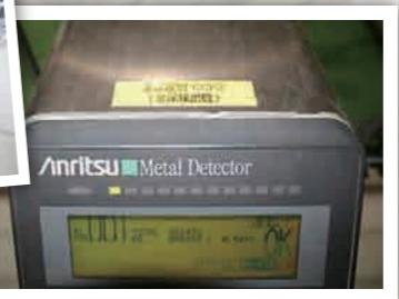
4 金属探知機です。探知は、精選時および出荷前の二重で実施しています。探知機が作動した場合、ラインごと止めて確認します。
